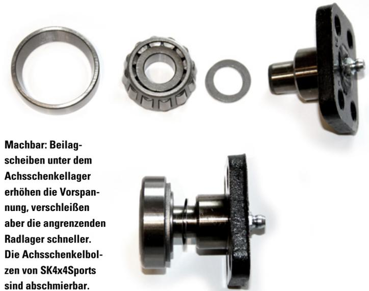
**Machbar:** Beilagscheiben unter dem Achsschenkellager erhöhen die Vorspannung, verschleifen aber die angrenzenden Radlager schneller. Die Achsschenkelbolzen von SK4x4Sports sind abschmierbar.
