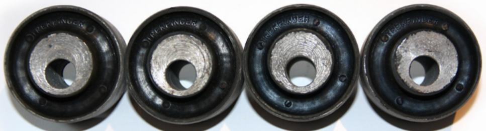
**Nicht mittig:** Verschiedene Hersteller haben Längslenkerbuchsen mit Nachlaufkorrektur entwickelt. Auch sie minimieren die Gefahr des Lenkradflatterns.
