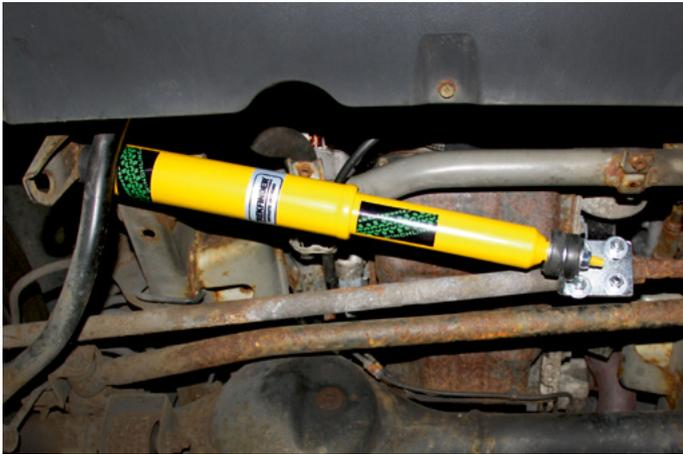
**Nicht ab Werk:** Der Jimny hat bei der Auslieferung keinen Lenkungsdämpfer. Ihn nachzurüsten geht relativ schnell und einfach.
